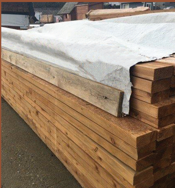
Exemple d'une pièce de retenue des emballages de protection pour le bois
