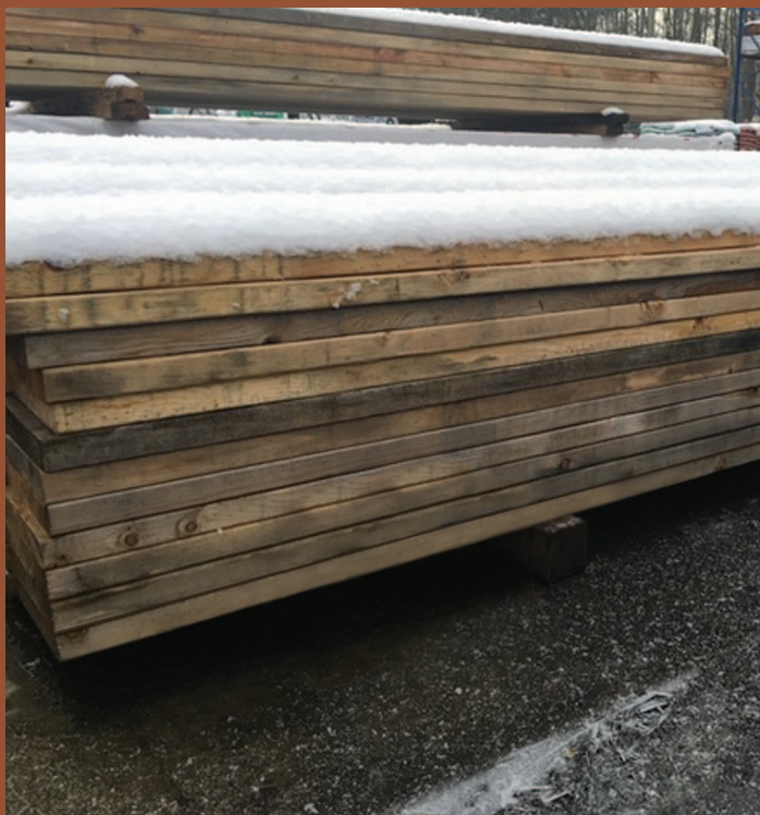
Exemple de bois de charpente blanc non protégé
