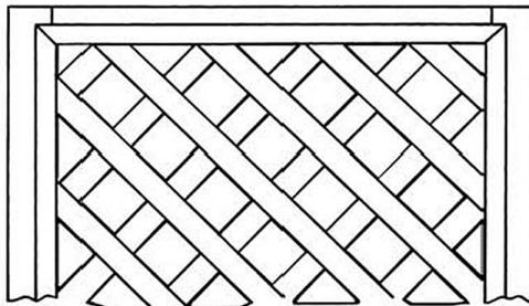
Lorsque vous fixez le treillis sur une structure de soutien ou un poteau, installez toujours le treillis sur l'extérieur de la structure afin de permettre l'expansion.
