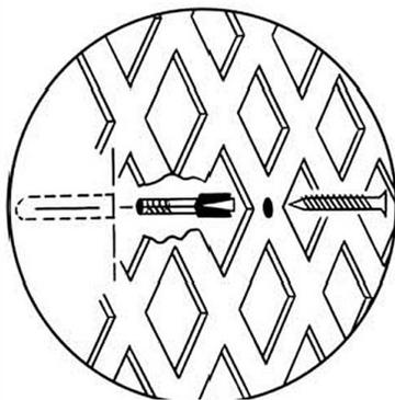
Lorsque vous faites l'installation du treillis sur une surface plate, pré-percez des trous surdimensionnés et utilisez des ancrages muraux.
